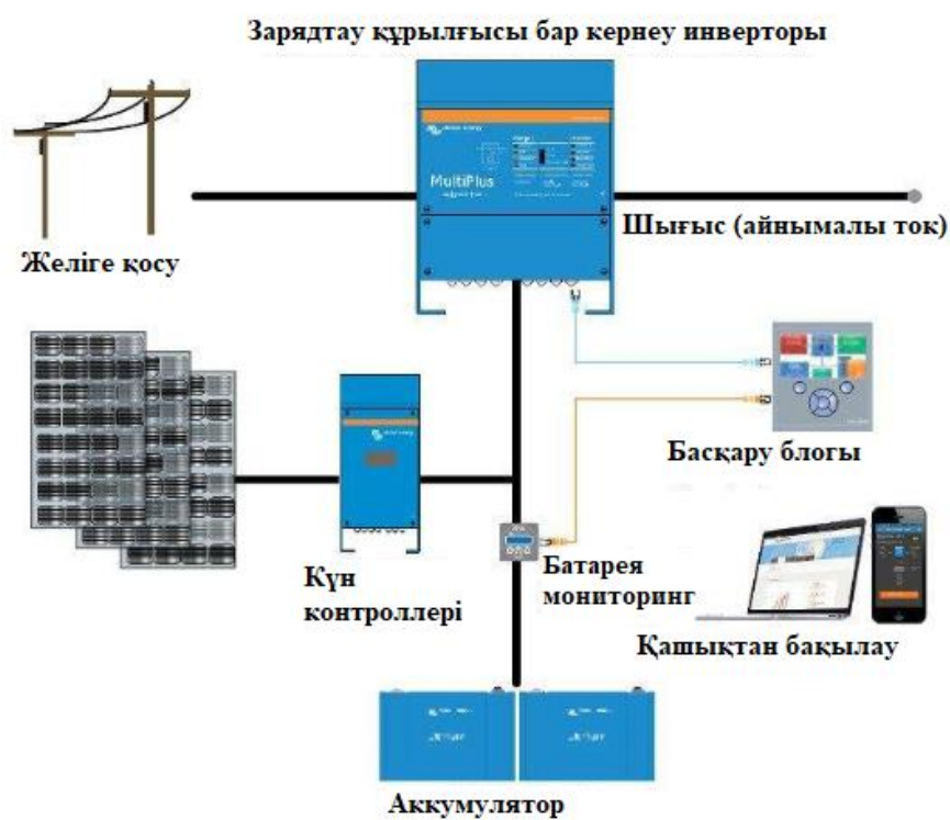
3-сурет - Автономды типтегі айнымалы токты желілік электр станциясының схемасы
