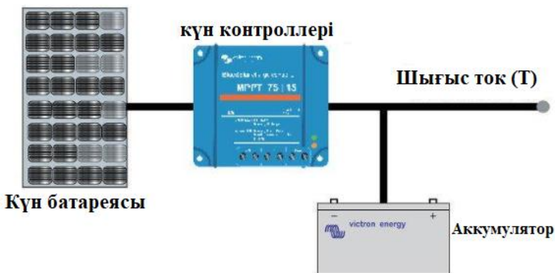
1-сурет - Автономды типтегі тұрақты токты электр станциясының схемасы
